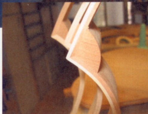
Neben dem Mittelblock das einzige massive Stück Holz im Korpus: Der untere Zargenklotz.
